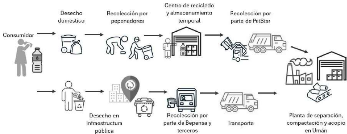
Figura 14. Esquema de la trayectoria de las botellas de PET post-consumo que llegan a la planta de acopio en Umán, Yucatán. Elaborado por la autora.
