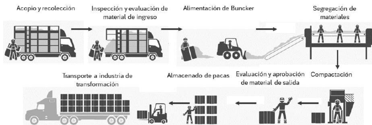
Figura 5. Proceso que comprenden la etapa de separación del reciclaje de PET. Modificado de PetStar, 2022.
