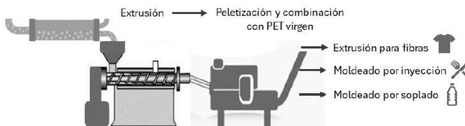
Figura 7. Tecnologías para el reprocesamiento de los plásticos. Modificado de Li et al., 2022.
