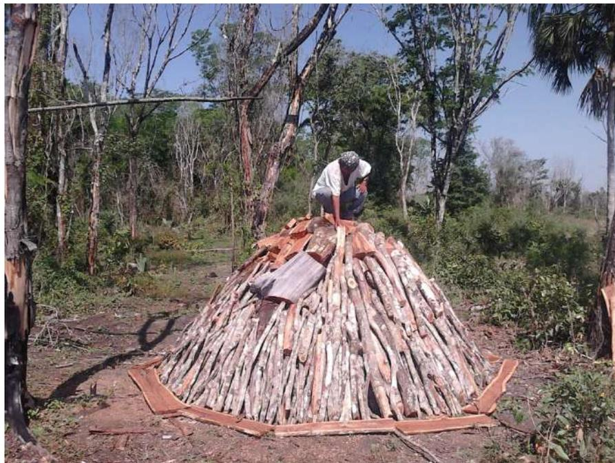
Figura 21. Construcción de un horno de carbón.
