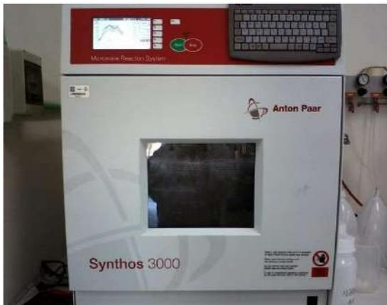
Figura 16. Sistema de reacción de microondas Synthos 3000.
