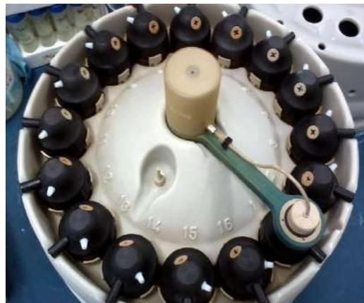
Figura 17. Recipientes de teflón cerrados, en el rotor del digestor.
