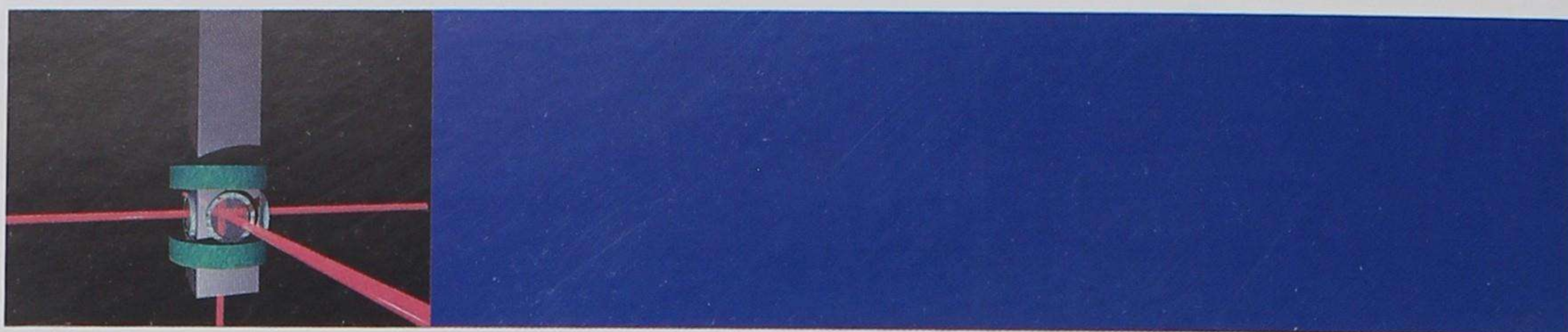
Figura 6. Esquema de la trampa utilizada en la creación del condensado de Bose-Einstein. Los anillos grandes verdes horizontales son electroimanes y los tubos rojos son los láseres.
