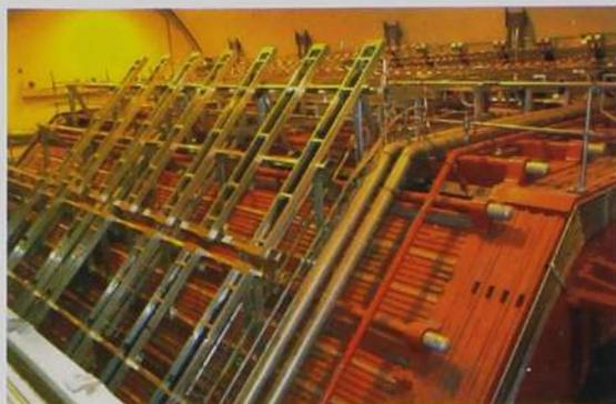
Figura 1. El detector de rayos cósmicos ACORDE, ubicado en la parte superior del magneto de ALICE.
