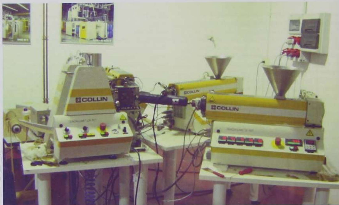
Figura 2. Equipo de extrusión y el tren de estiramiento utilizados para la obtención de las películas flexibles.
