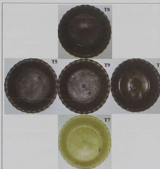
Figura 5. Materiales biodegradables obtenidos como efecto del contenido de glicerol y el contenido de fibra. Tratamientos: (5) 0 % de glicerol, 10% de fibra; (6) 0% de glicerol, 20% de fibra; (7) 10% de glicerol, 10% de fibra; (8) 10% de glicerol, 20% de fibra, y (9) 10% de glicerol, 10% de fibra.
