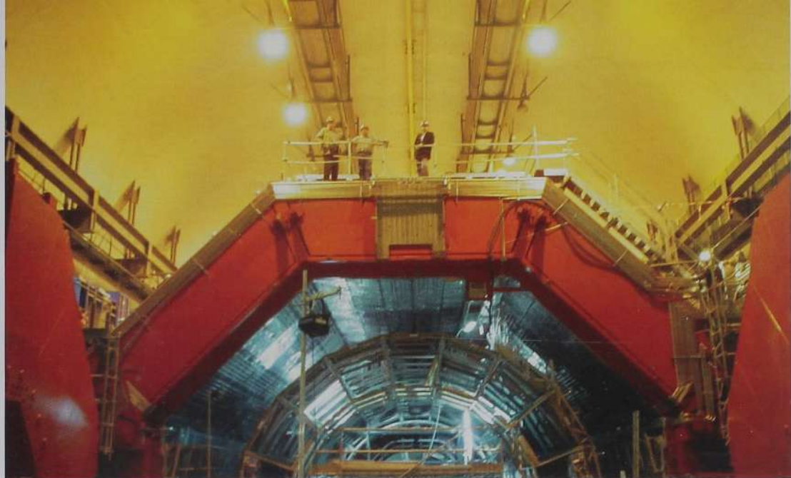
Estructura de acero de ALICE. En su interior está el magneto superconductor y en la parte superior se encuentra el detector de rayos cósmicos.
