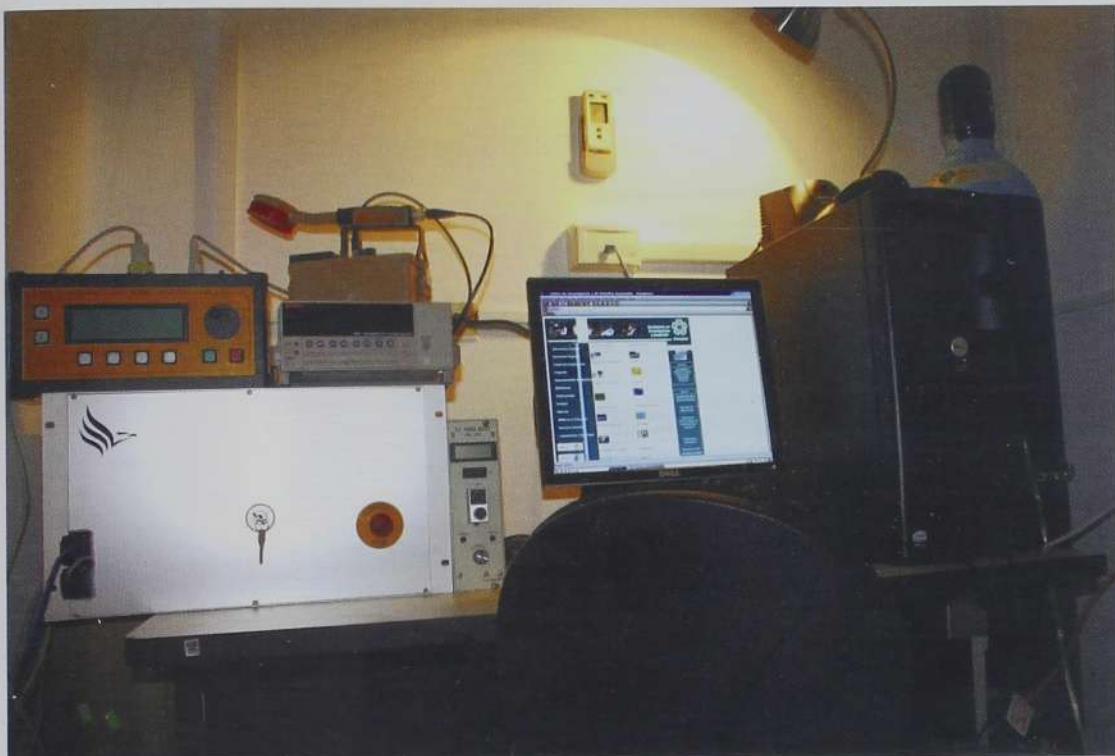
Figura 7. Arreglo experimental que muestra la posición del cristal analizador, así como del fantasma y del detector.
