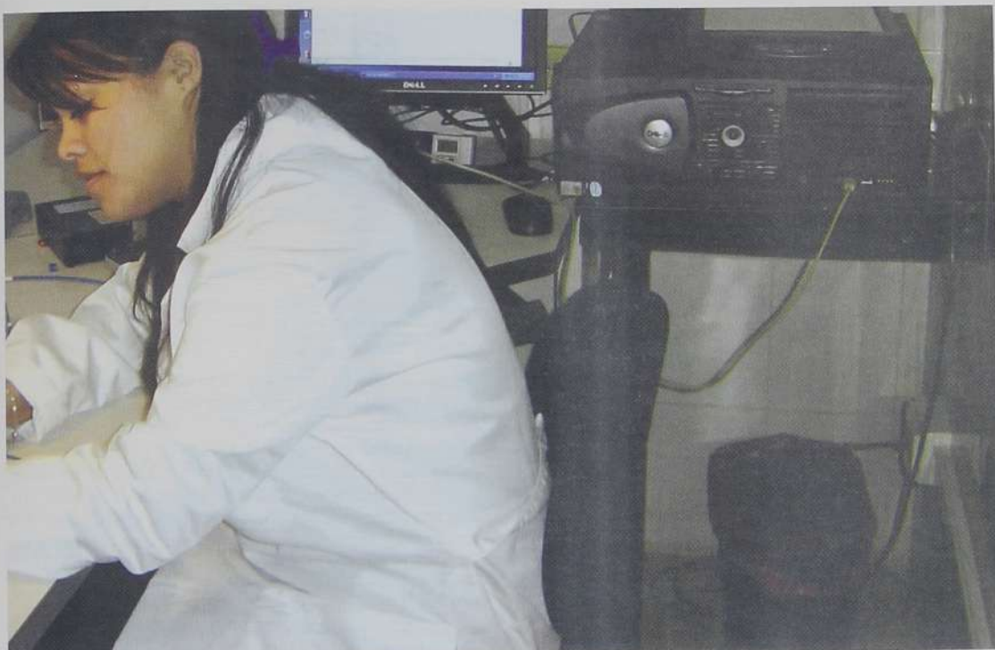
Cuarto de control del laboratorio de rayos X en la Unidad Monterrey. Se observa la consola de mando de la fuente y algunos componentes de electrónica involucrados en la operación de algunos detectores.
