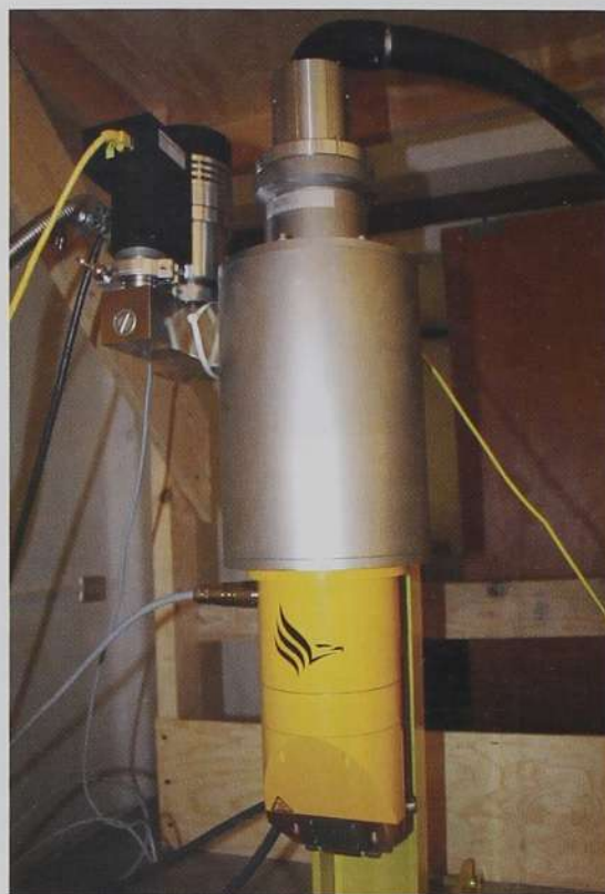
Figura 8. Adquisición de la rocking curve , que muestra la reflectividad del cristal como función del ángulo de incidencia del haz monocromático de rayos X.
