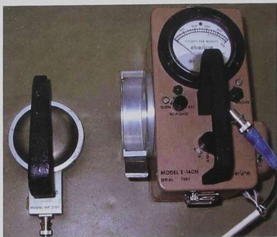
Figura 7. El detector Geiger-Muller es un aparato utilizado con mucha frecuencia en las instalaciones donde existen fuentes radiactivas. Su mecanismo de operación se basa en el proceso de ionización que produce la radiación al interactuar con él.
