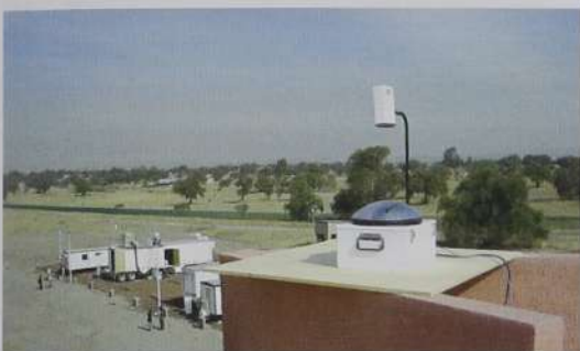
Fig. 10. Cámara hemisférica para medir la cubierta de nubes. Vista al Noroeste en T1.
