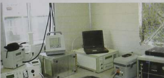
Fig. 12. Interior de trailer UNAM. Equipo para medir las propiedades ópticas de las partículas (izquierda). Analizadores de mercurio y formaldehído (derecha).
