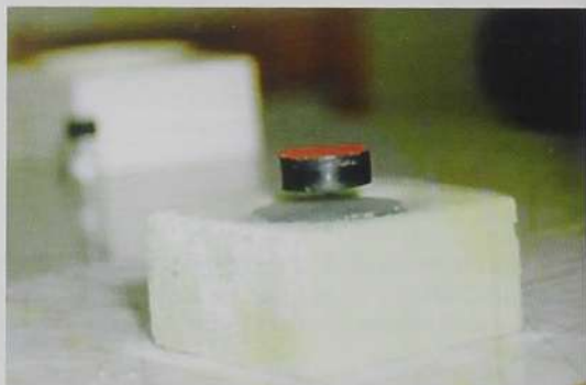
Fig. 11. Efecto Meissner, en el cual el campo magnético no penetra un material superconductor (en azul). Foto de una pastilla superconductora levitando (flotando) sobre un imán.
