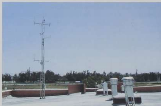
Fig. 9. Torre meteorológica en T1. Con dos anemómetros sónicos, sensores de temperatura, humedad relativa, presión y radiación colocados a 5 y 10 metros. Vista al Este en T1.
