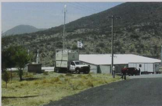
Fig. 14. Unidad móvil en T2, equipada con analizadores de gases (ozono, monóxido de carbono, dióxido de azufre y óxidos de nitrógeno) y torre meteorológica. Vista al Oeste.
