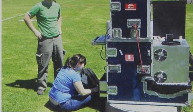
Fig. 3. Instalación del sistema Lidar para medir la estructura vertical de aerosoles en T0. Piotr Lewandowski y Heidi Holder (Universidad de Iowa).
