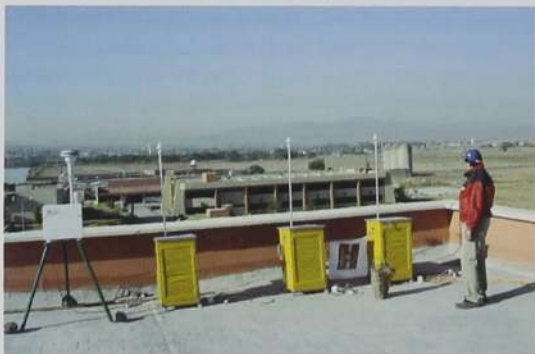
Fig. 8. Impactadores de cascada para obtener composición química por distribución de tamaño de partículas con diámetros de 0.18 a 10 \mu\text{m} y colector de partículas \text{PM}_{2.5} (izquierda). Vista al Sur en T1.
