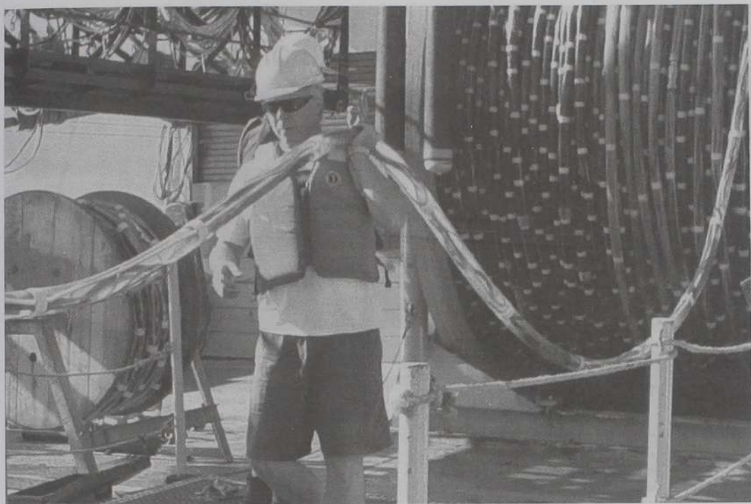
Seis kilómetros de cable que contiene sensores sísmicos e hidrófonos.
