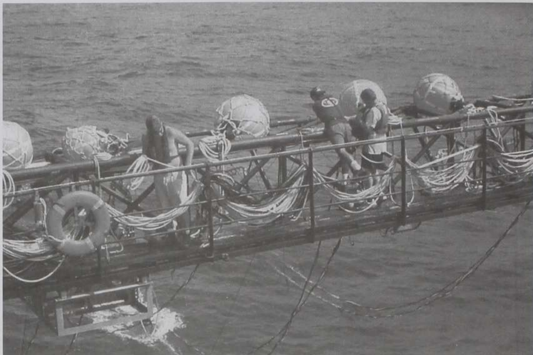
Despliegue de pistolas de aire para trabajos sísmicos en el mar.
