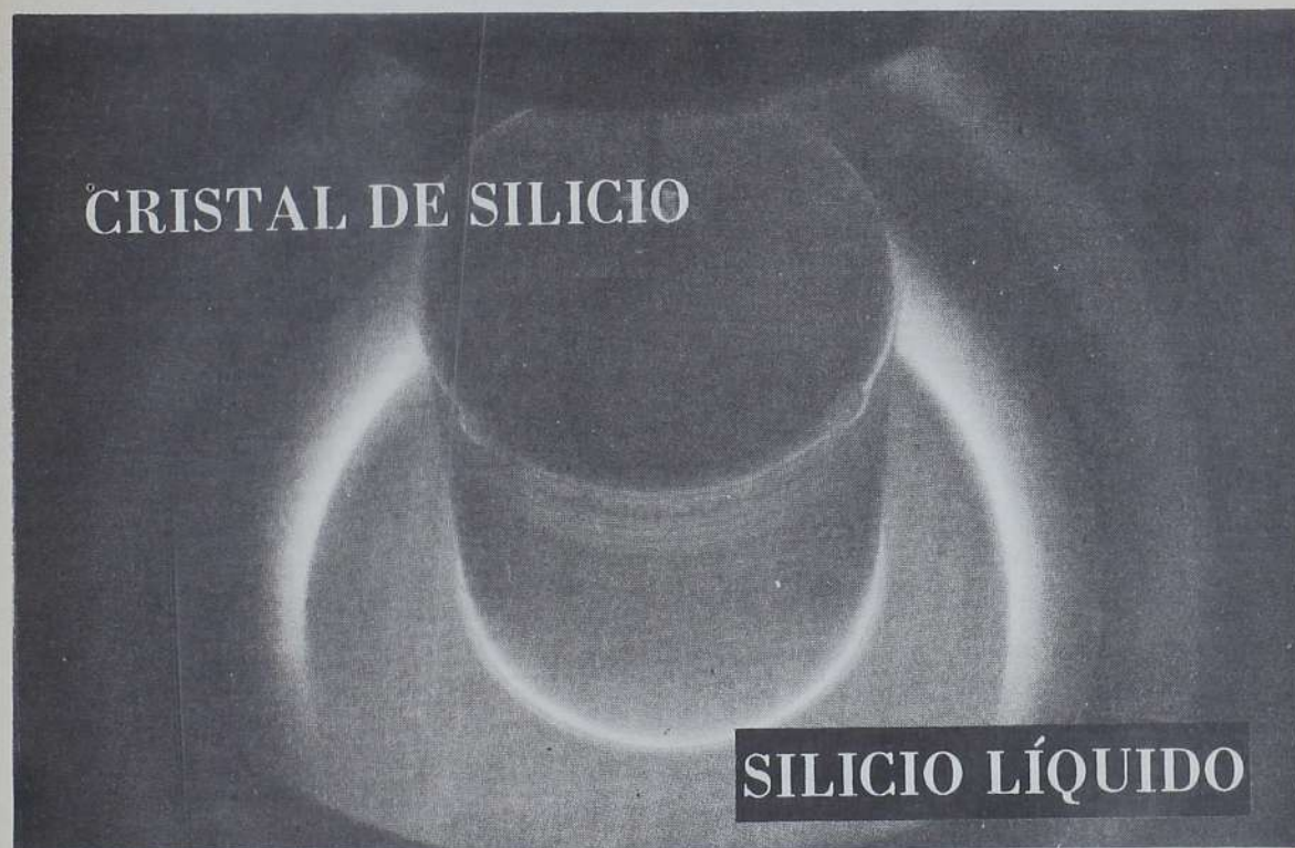
En la foto, en la parte inferior el silicio se encuentra fundido; en la parte superior vemos el lingote de silicio monocristalino que servirá para la construcción de las celdas. La técnica mostrada es la de Czochralski.
